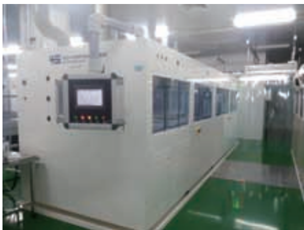
图1 硅抛光片全自动湿法清洗设备外形
