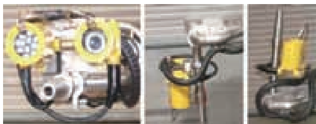
图 15 COS 人孔加农喷射清洗系统实物
