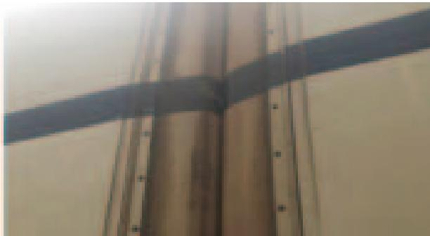
图2 风挡老化现象严重
