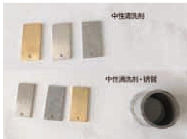
图 4 中性清洗剂腐蚀率实验试片外观
