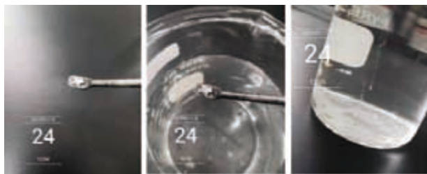
图 10 空冷器翅片垢样溶解试验
