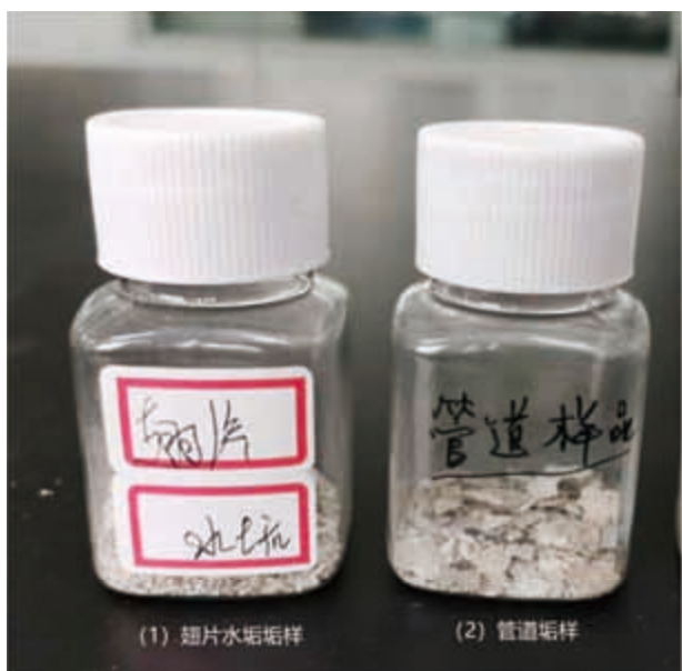
图 5 空冷器表面垢样
