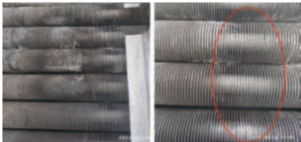
图13 空冷器翅片表面污垢局部清洗效果
