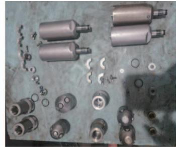
图 2 自旋转喷头解体图
