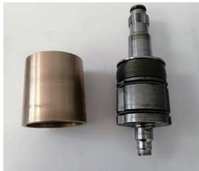
图 3 自旋转喷头的密封
