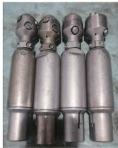
图 1 自旋转喷头外型
