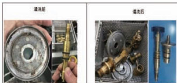
图 3 制动阀清洗前后对比图
